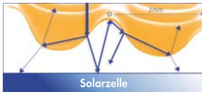
Abbildung 2: Schematische Darstellung des Lichtfalleneffekts
